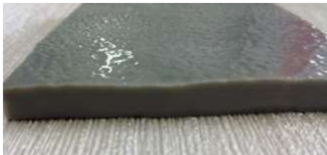
Muestra de STM usado para la rehabilitación de los canalones
